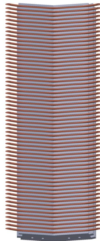
Mini TPC test field cage
